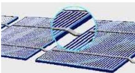
FIGURA 2 – Construção dos circuitos com as células fotovoltaica. Fonte: Criação própria, 2020.
