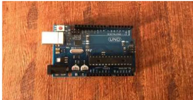
FIGURA 4 – Placa Arduino Uno.
