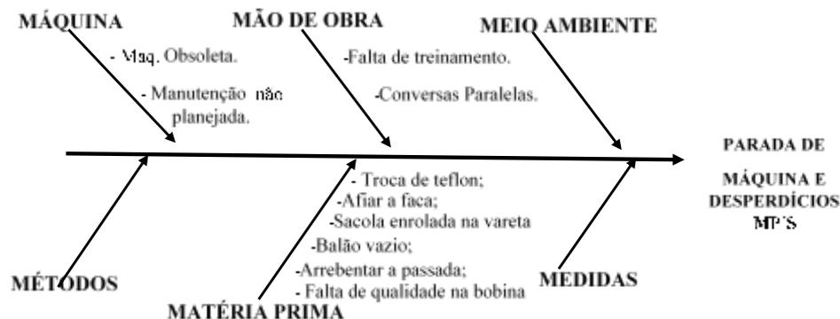
FIGURA 7 - Diagrama de Causa e Efeito identificando as causas de parada de máquina e desperdícios.
